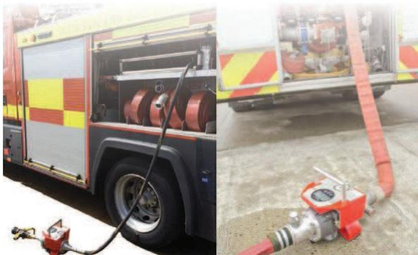
Abb. 4.3: Prüfung von Feuerwehrequipment mit Ein- und Auslaufstrecke
