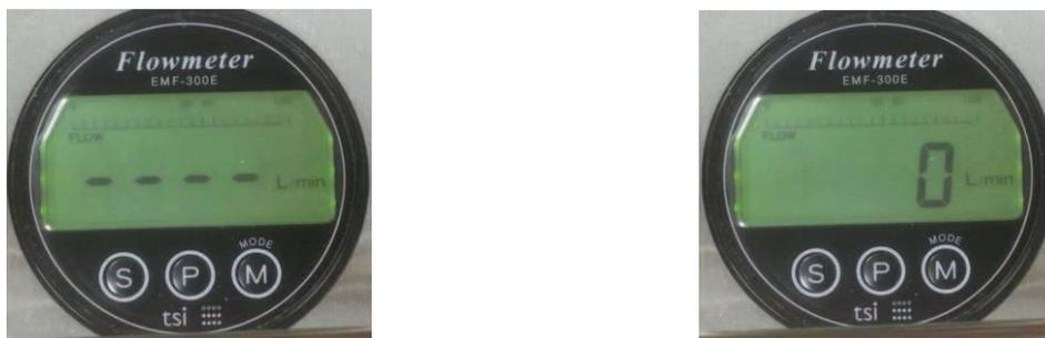
Abb. 6.2: Displayanzeige bei Selbsttest und danach im Betriebszustand
