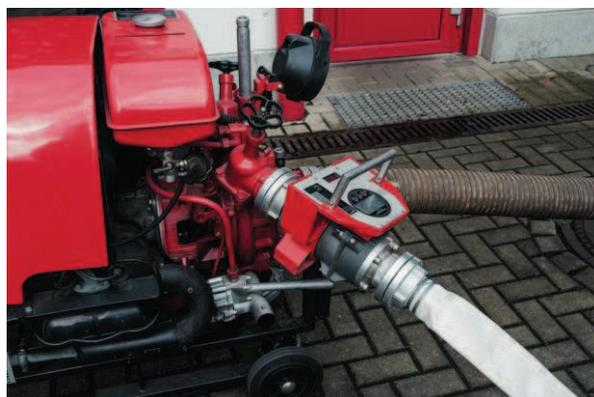
Abb. 4.4: Prüfung einer TS-Pumpe mit Auslaufstrecke und Druckvernichter am Ende
