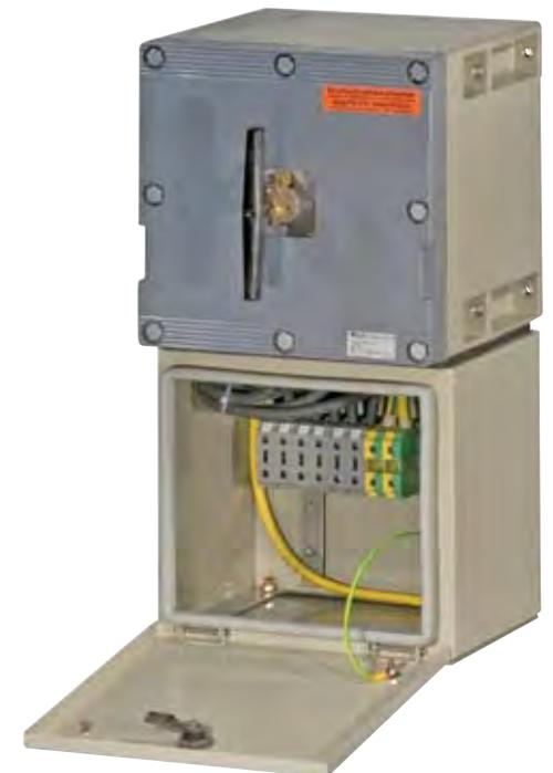
Drehschalter in druckfest gekapseltem Gehäuse der Serie GHG 64 mit Flachsplatt mit angeflanschem Ex-e-Anschlusskasten für den indirekten Anschluss.
