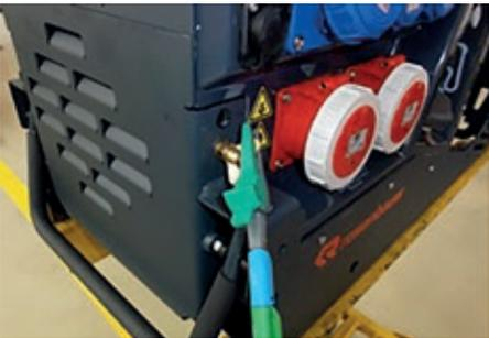
2. An der Metallfläche beim Motor Durchgangswiderstand zum PE-Kontakt messen:
