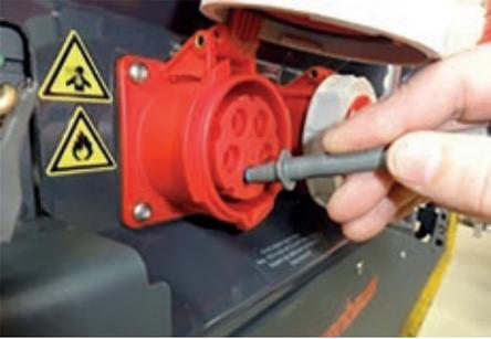
**2B) Prüfung Potentialausgleich an Metallflächen, Generator auf AUS:**
