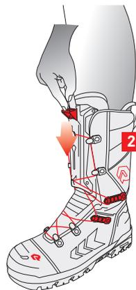
**2** Für das Ausziehen des Stiefels wird über einen Druck auf die zentrale Schnalle das gesamte Verschlussystem geöffnet.
